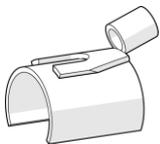
Abb. 21: Einspeiseschuh mit Quetschverbindung
