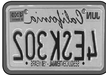
IMAGE INVERSÉE DE GAUCHE À DROITE TELLE QU'ELLE APPARAÎT AVEC UN RENVOI À 90° SUR UN RÉFLECTEUR OU UN SCHMIDT-CASSEGRAIN
