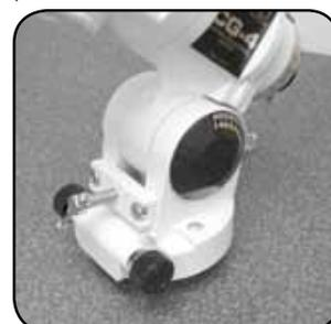
3. Ajustez l'altitude de la monture jusqu'à ce que l'indicateur de latitude soit orienté sur votre latitude. Le déplacement de la monture affecte l'angle sur lequel l'axe polaire est dirigé. Pour des informations détaillées sur la manière de régler la monture équatoriale, veuillez consulter la rubrique « Réglage de la monture » du manuel de votre télescope.
