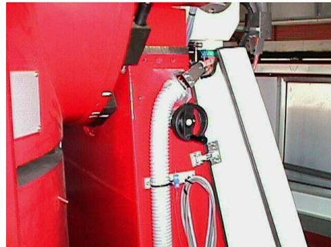
14. Couper l'alimentation électrique du moteur et le déconnecter. **Danger 380 Volts**
