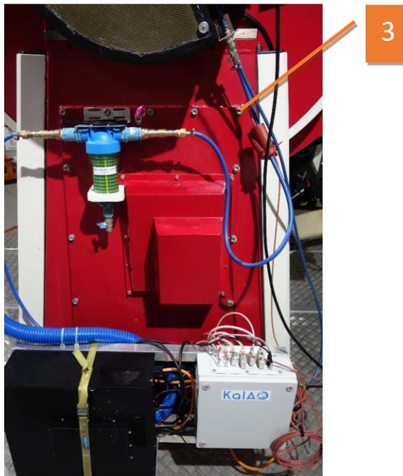
4. Déposer provisoirement le filtre Kalao entre le PC et le boîtier électrique
