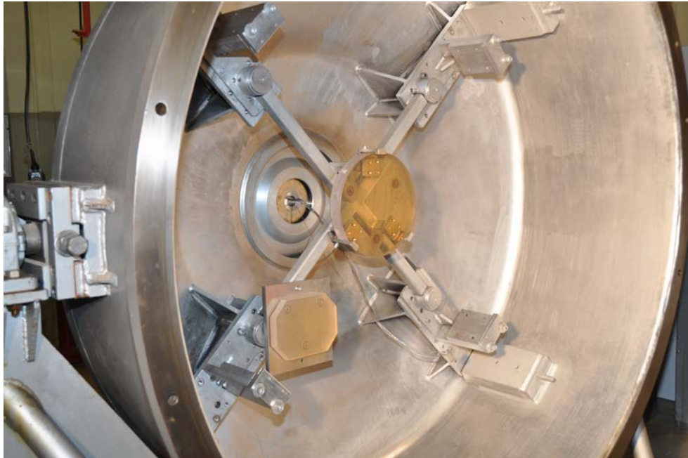
Disposition de M2 et M3 dans la chambre à vide
