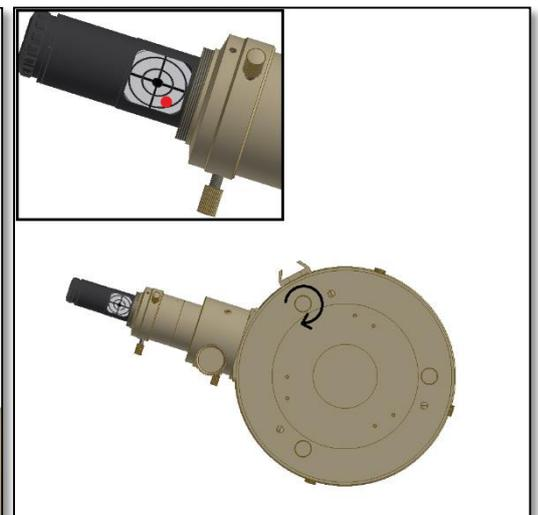
Figure 4. Tournez la fenêtre de visualisation du laser de façon à pouvoir apercevoir la tache laser lors du réglage du miroir primaire.
