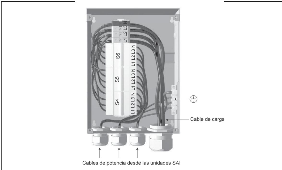
**Figura 20.** Ruta de los cables del SPM
