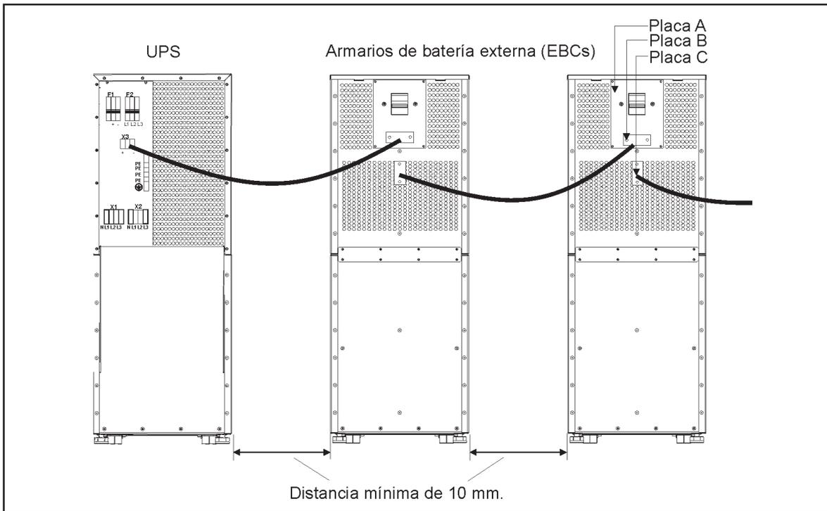
**Figura 17.** Conexión del SAI y de los armarios de batería externa
