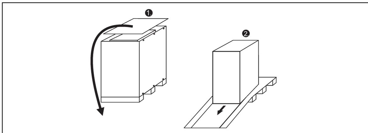
**Figura 1.** Instrucciones para sacar el equipo del palé.
