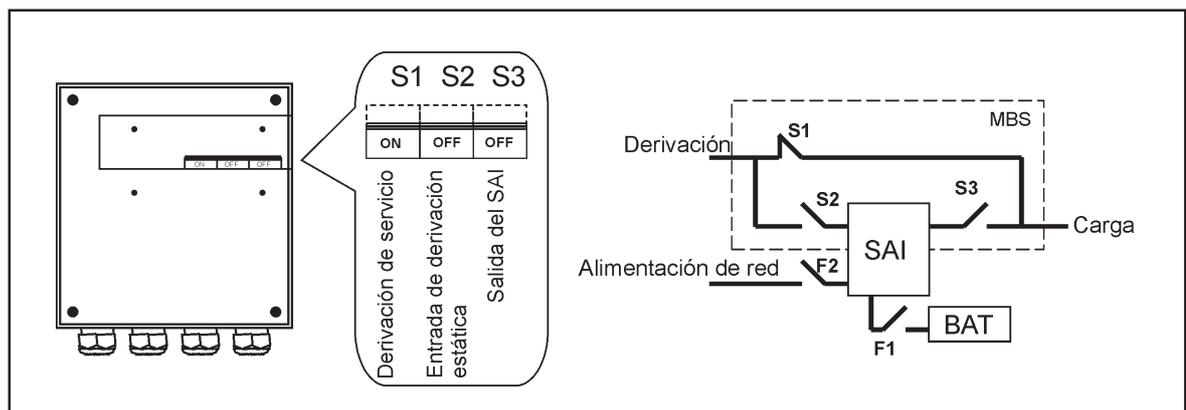
**Figura 39.** Posiciones de servicio (la derivación alimenta la carga) de los tres interruptores MBS.
