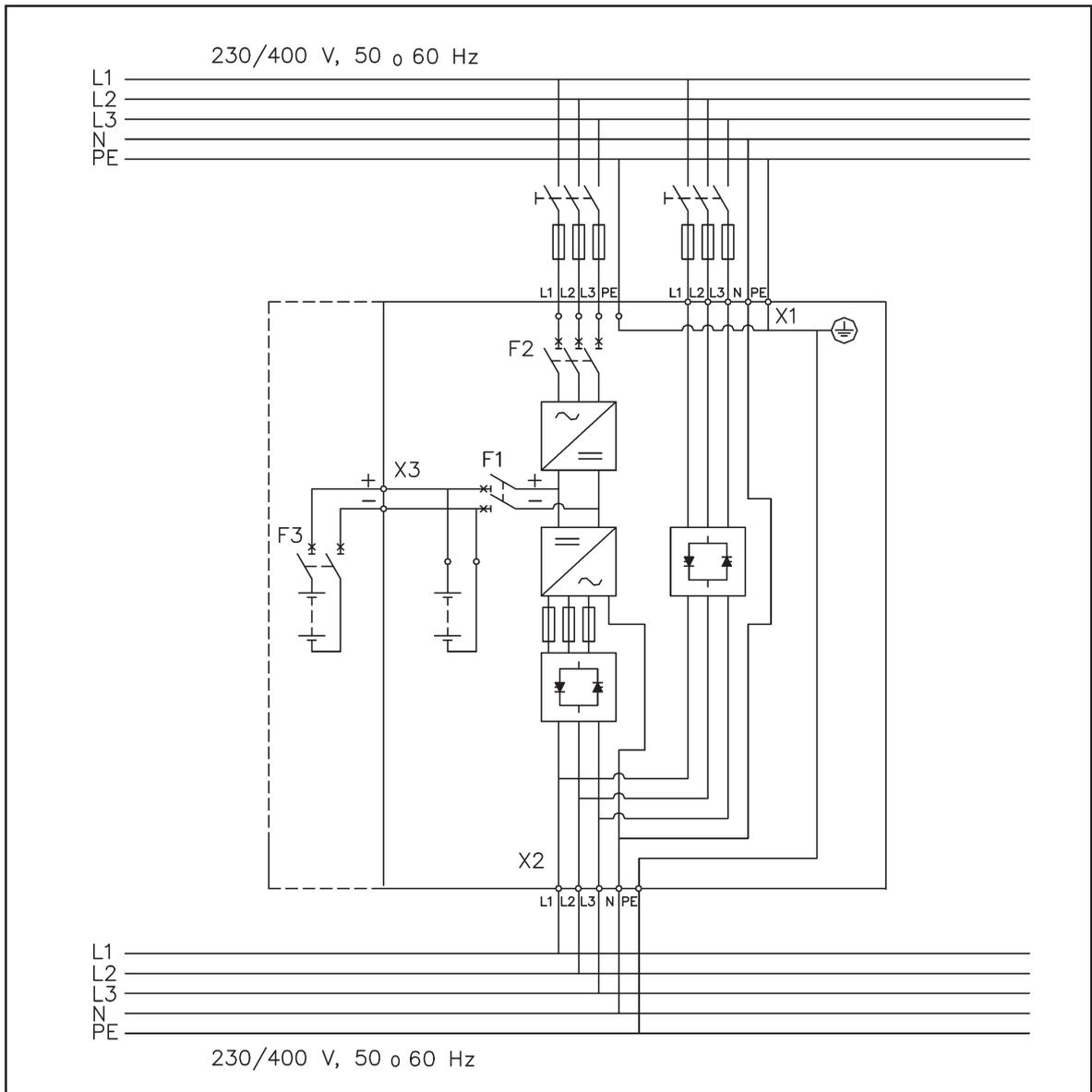
**Figura 15.** Diagrama de cableado del modelo N de SAI
