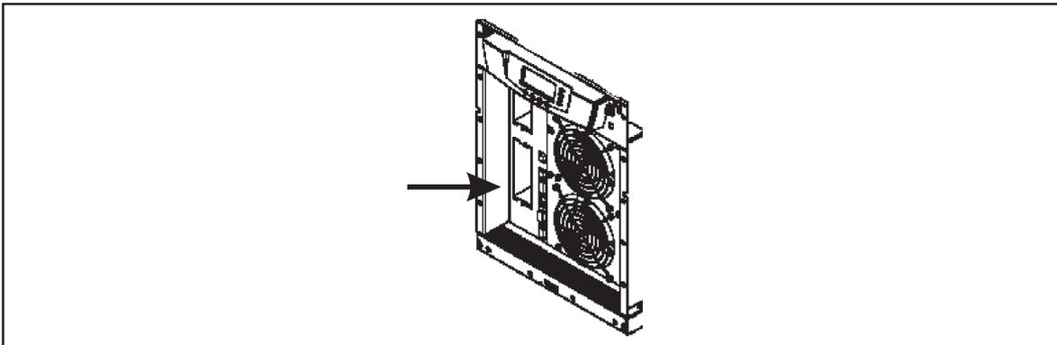
**Figura 23.** Ubicación de los terminales de cable de control.
