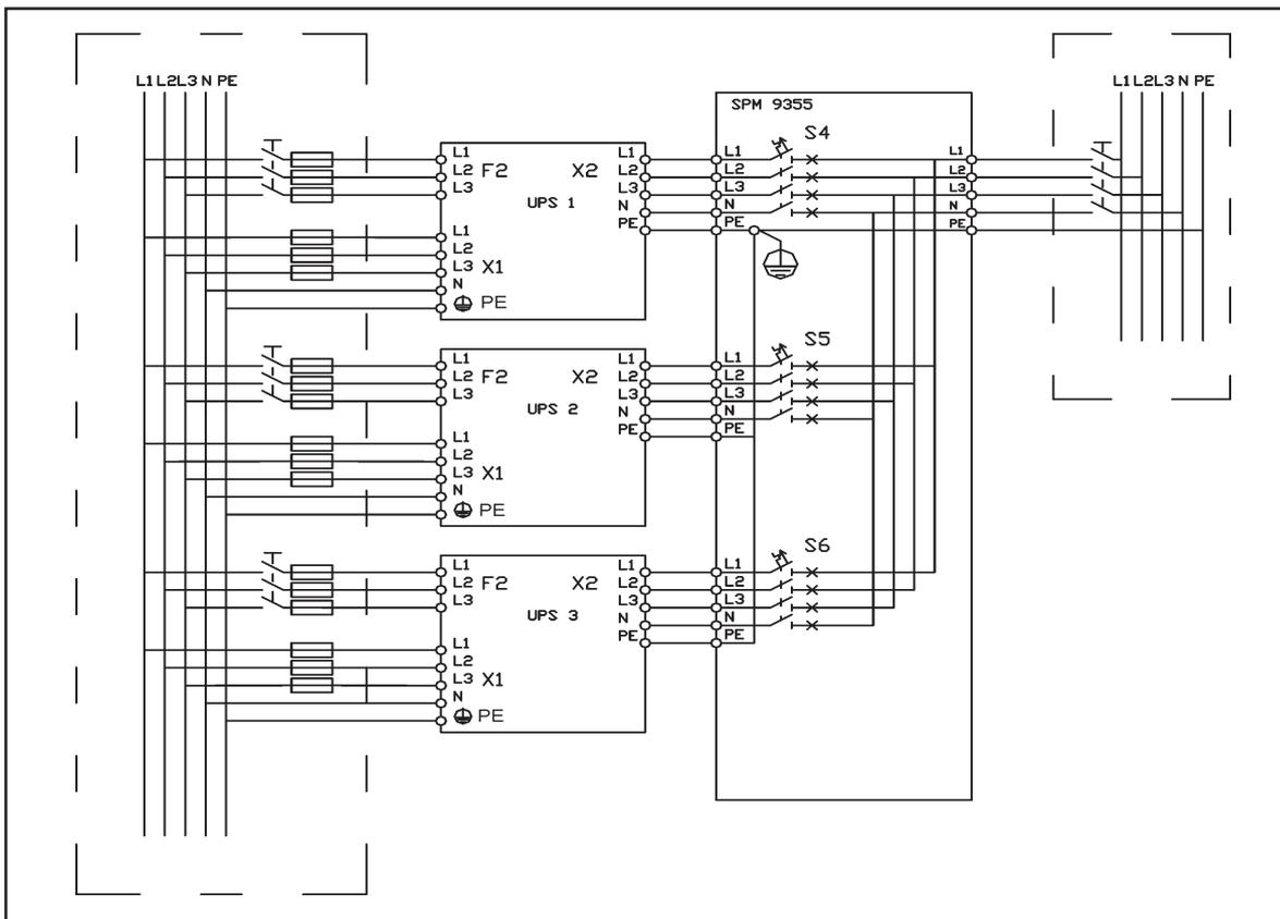
**Figura 21.** Diagrama de cableado del SPM9355 con tres unidades SAI conectadas
