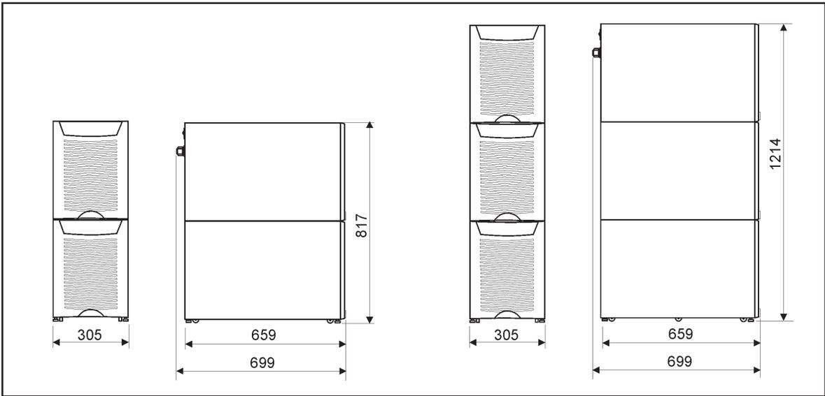
**Figura 43.** Modelos de armario de batería externa con (2) y (3) secciones.
