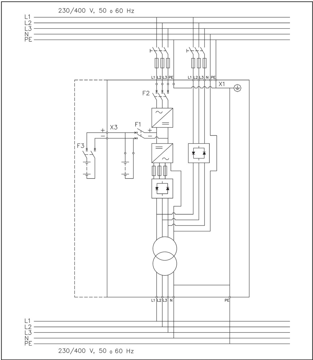
**Figura 16.** Diagrama de cableado del modelo NT de SAI
