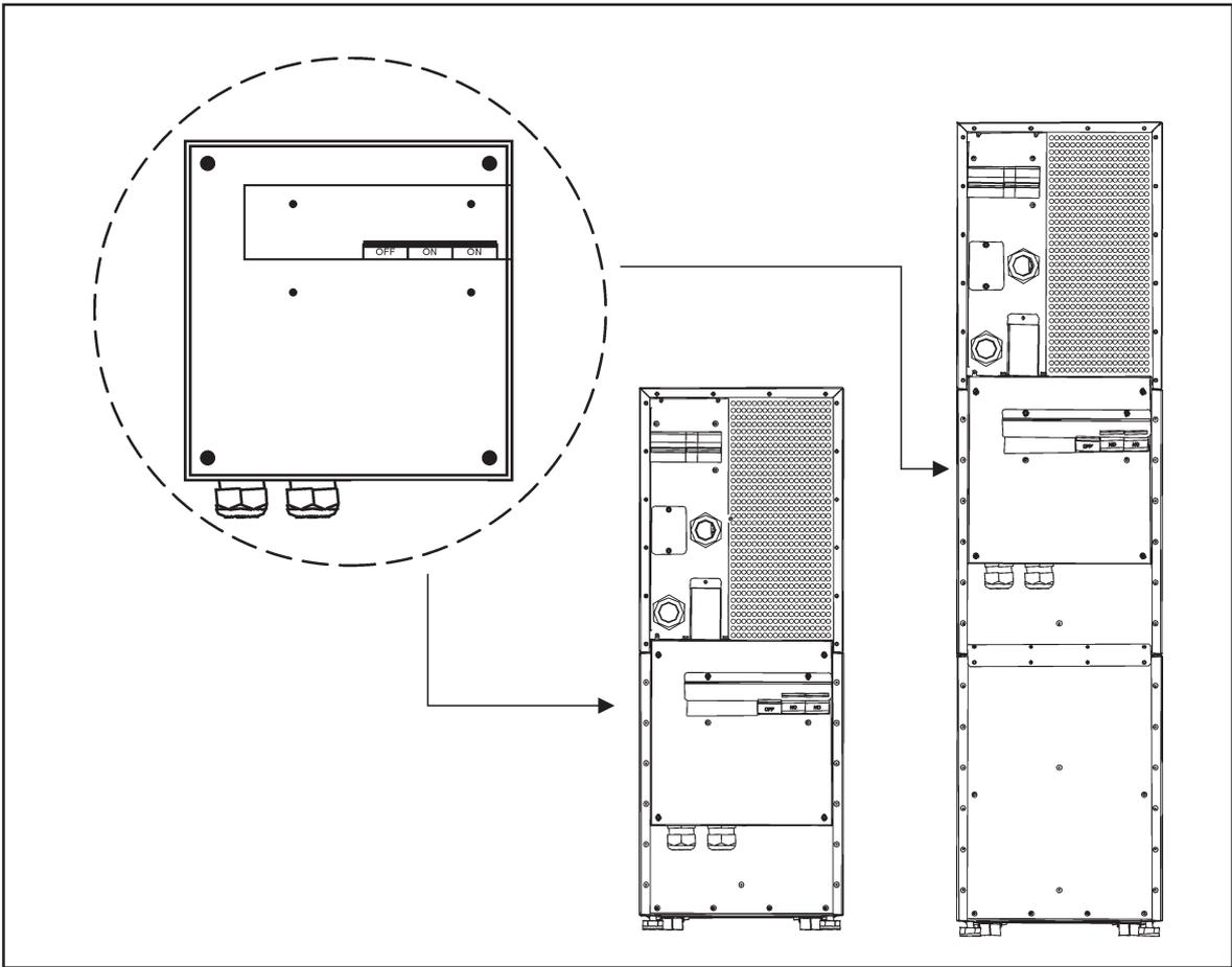
**Figura 7.** Conmutador de derivación mecánica instalado en la parte trasera.
