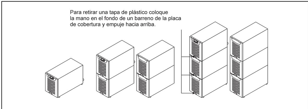
**Figura 5.** El SAI y los armarios de batería externos.
