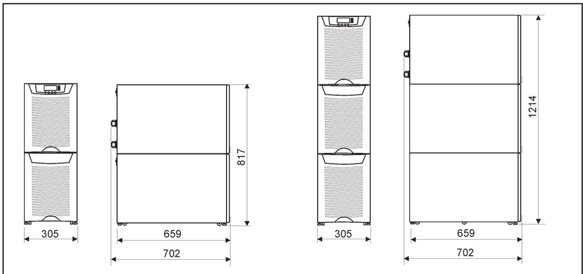
**Figura 41.** Modelos SAI con (1) y (2) secciones inferiores de batería.
