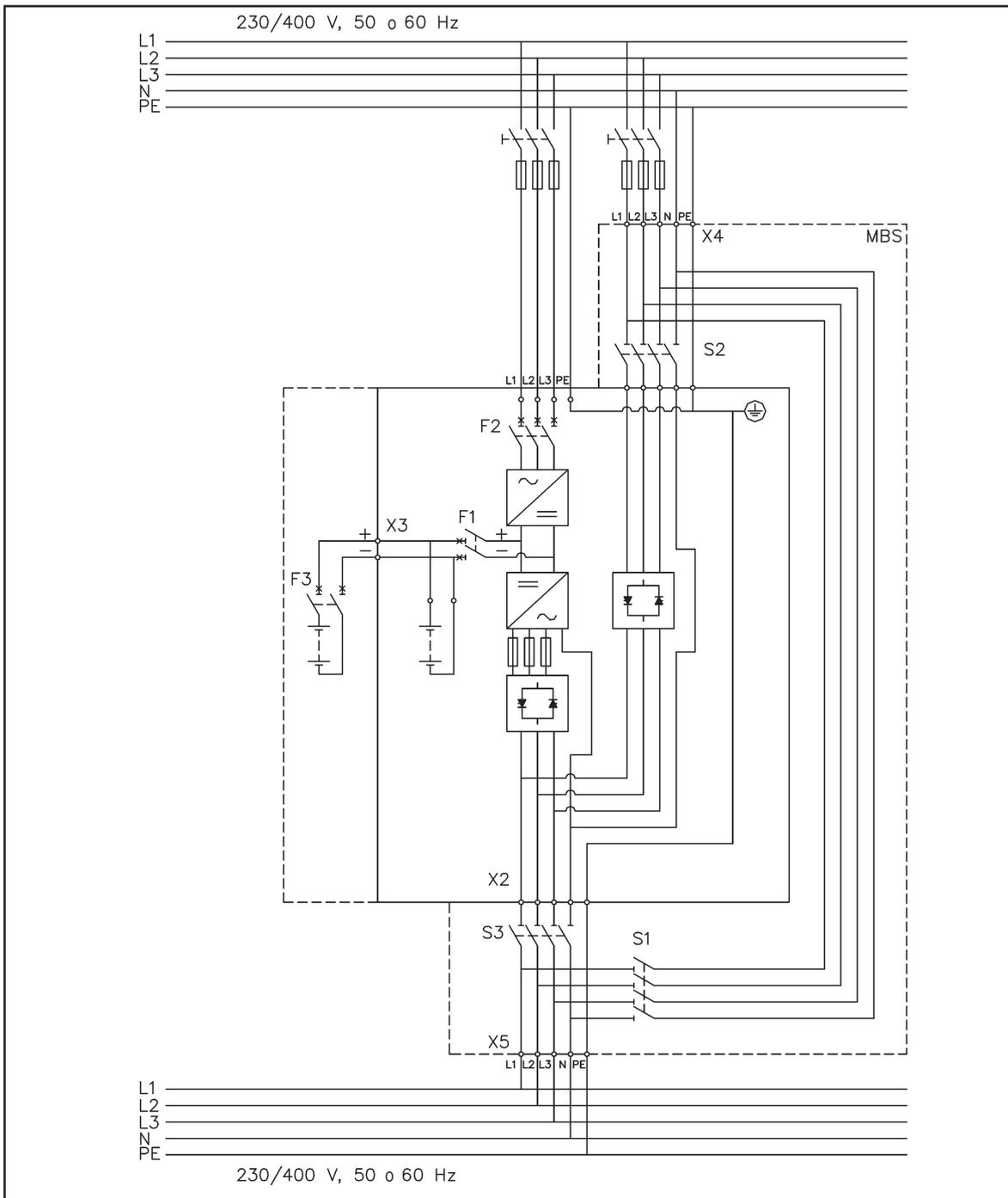
**Figura 14.** Diagrama de cableado del modelo N de SAI con MBS integrado.
