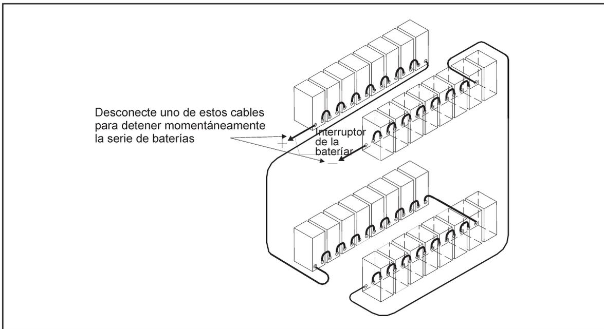
**Figura 18.** Para reducir al mínimo el riesgo para la seguridad, saque el cable + o - de la serie de baterías antes de conectar el SAI y los EBCs.
