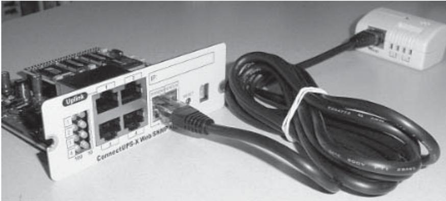
**Figura 28.** Conecte el módulo SNMP/Web y la Sonda de Control del Medio del SAI-X.
