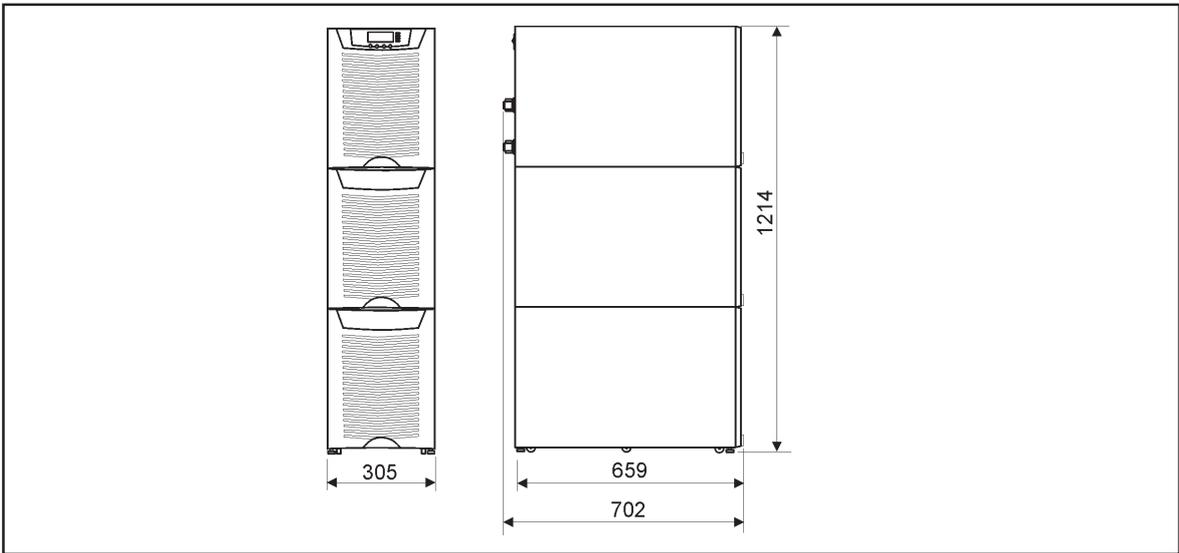
**Figura 44.** Modelos SAI con secciones de batería central y transformador inferior.
