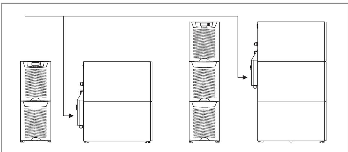
**Figura 6.** Instrucciones para la ubicación del conmutador de derivación mecánica.
