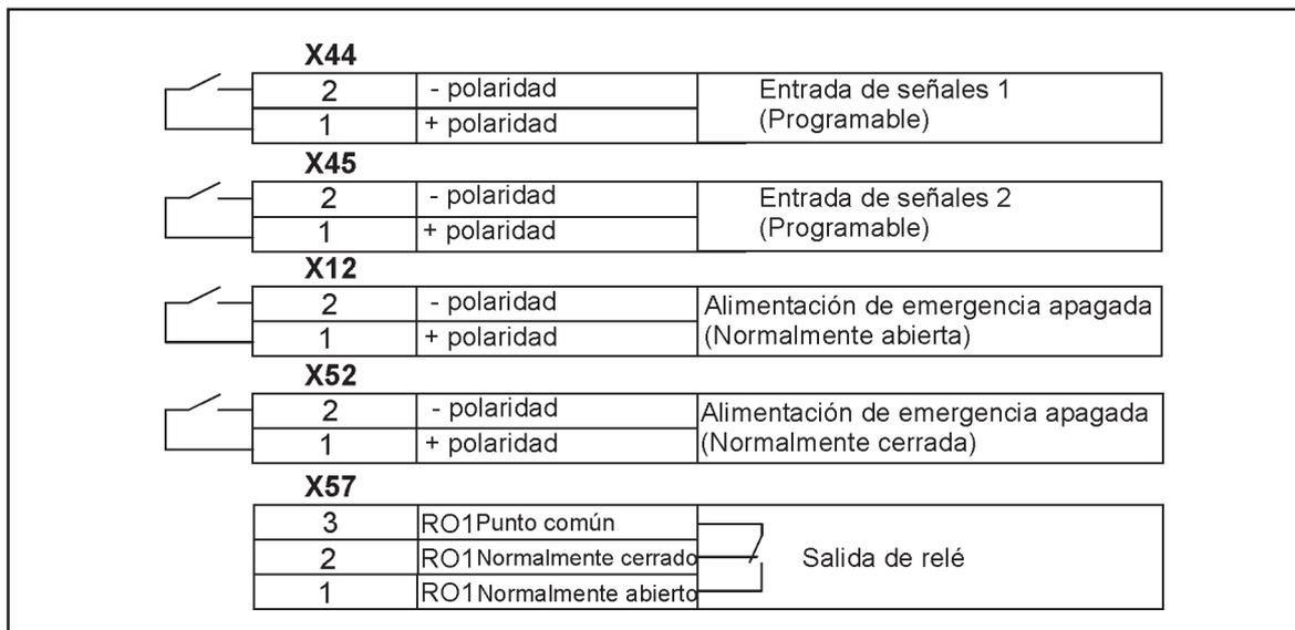
**Figura 25.** Conexiones del cable de control externo al SAI.
