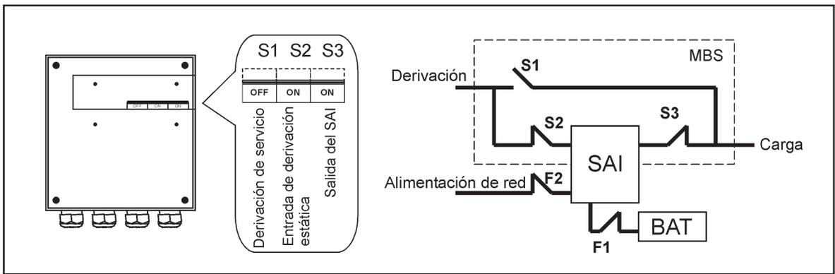
**Figura 38.** Posiciones normales (SAI alimentando la carga) de los tres interruptores MBS.
