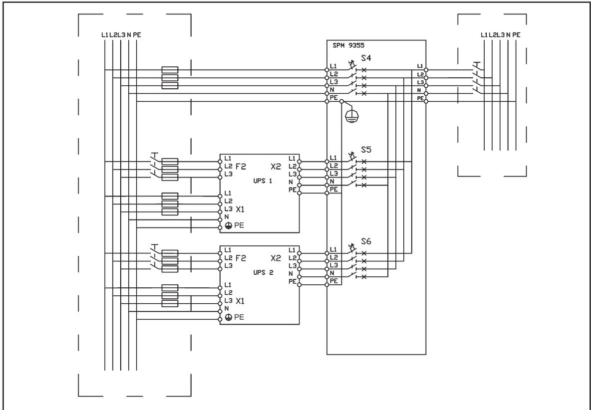
**Figura 22.** Diagrama de cableado del SPM9355 con dos unidades SAI y derivación conectadas
