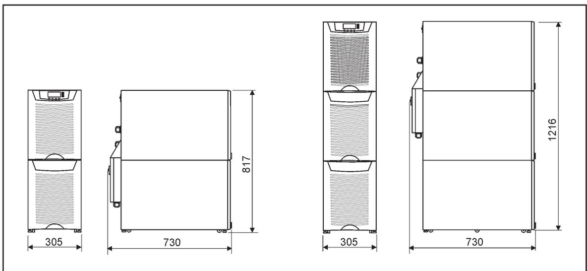
**Figura 42.** Modelos de SAI con (1) y (2) secciones inferiores de batería más MBS integrado.
