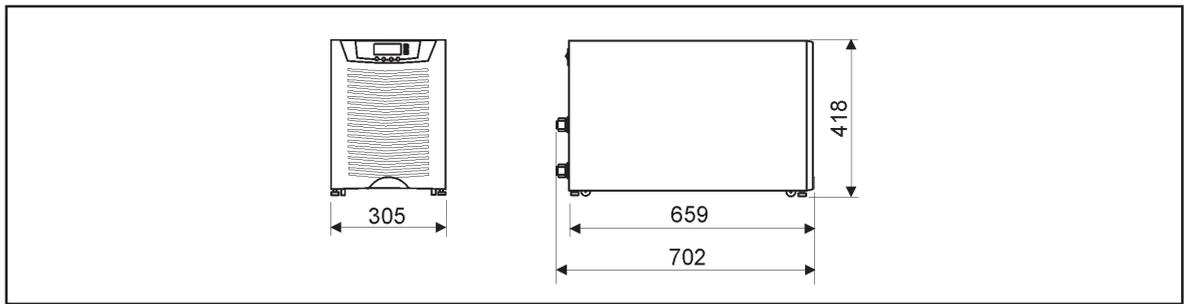
**Figura 40.** Modelos SAI sin secciones de batería.
